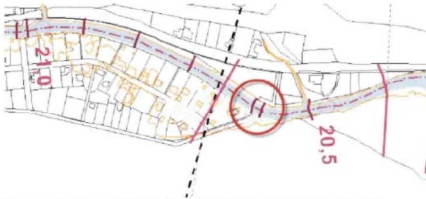
Abbildung 1: Überflutungsverhältnisse infolge HQ30, HQ100 und HQ300 (Quelle: ABU 2007)
